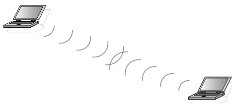
Abbildung 1: Schon mit zwei oder mehr drahtlosen Netzwerkkarten lässt sich ein einfaches Wireless LAN aufbauen.
